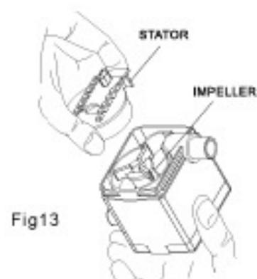
8. Sobald das Motorgehäuse entfernt ist, können Sie auch den Impeller (Propeller mit 3 Blättchen), der magnetisch fixiert ist, entfernen. Nutzen Sie einen Fingernagel um das Blatt anzuheben. (Fig. 14)
